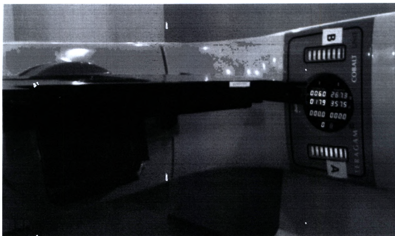
ГАНТРИ КАСАЕТСЯ СТОЛА – ИНДИКАЦИЯ АНТИКОЛЛИЗИОННЫХ ДАТЧИКОВ ГОРИТ РАЗРЕШАЮЩИМ ЗЕЛЕНЫМ.
