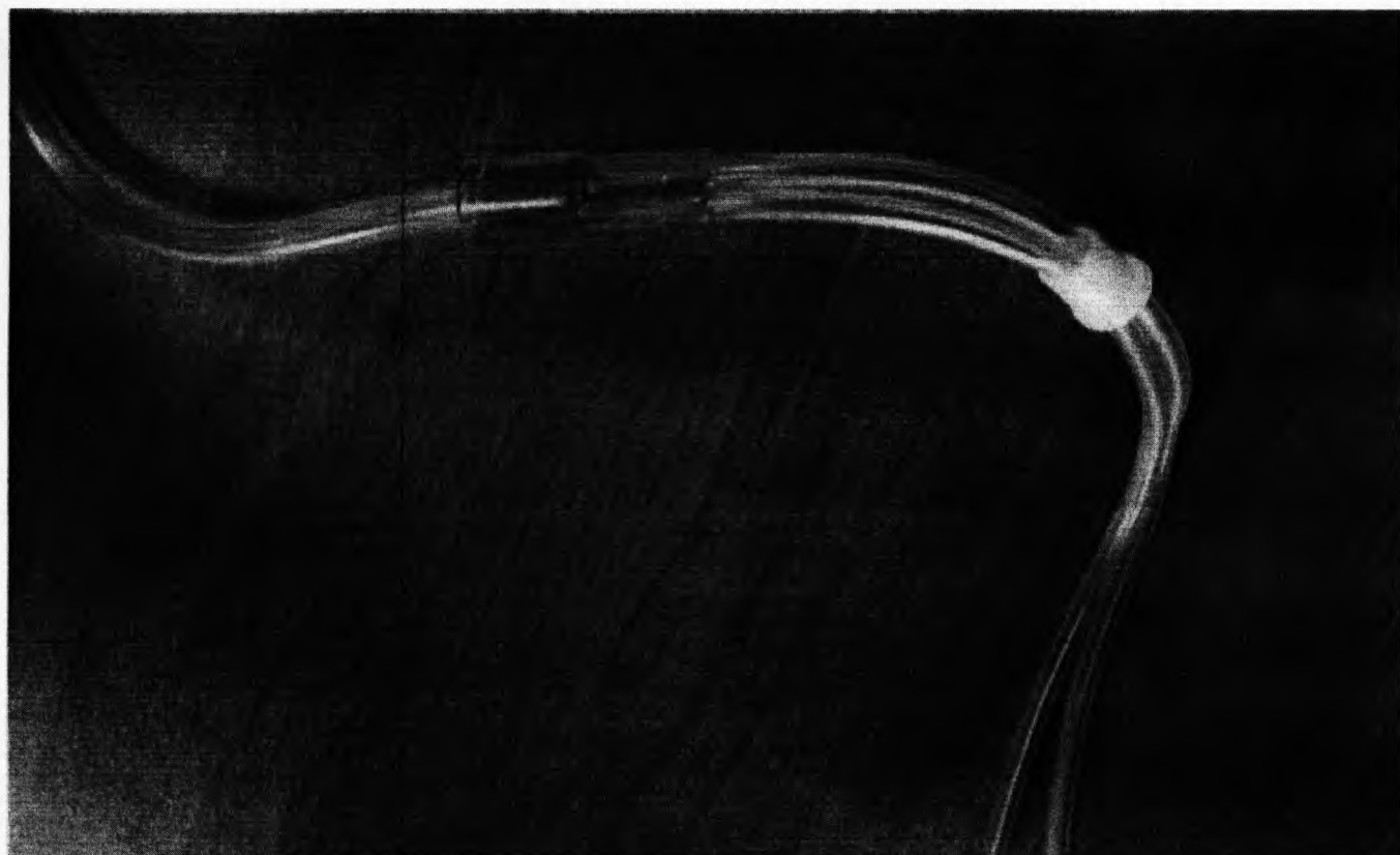
Соединение основной трубки и патрубка
